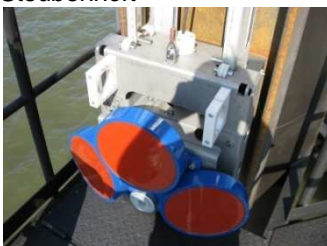
Abbildung 2: Schlitten (links) und Führungsschiene des HADCP (rechts)
