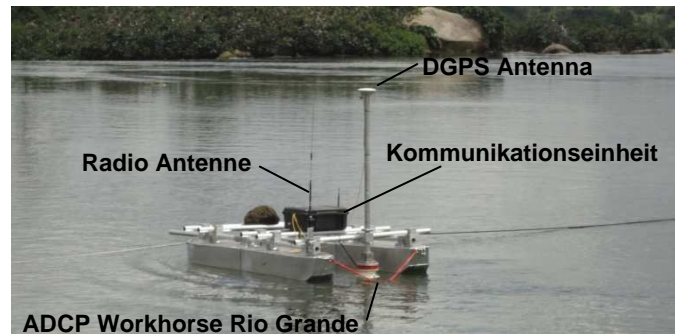
Abb. 3: Ponton als Meßgeräteträger mit ADCP
