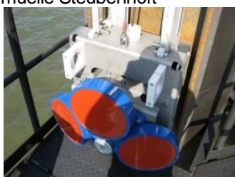
Imagen 2: Corredera (foto izquierda) y riel de guía del HADCP (foto derecha)
