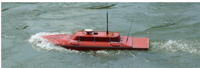
Fig. 2: Embarcación de medición por control remoto ADCP
