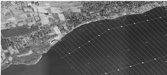
Fig. 1: Vue en plan des tracés à mesurer à la rive nord dans la région de Mardorf
