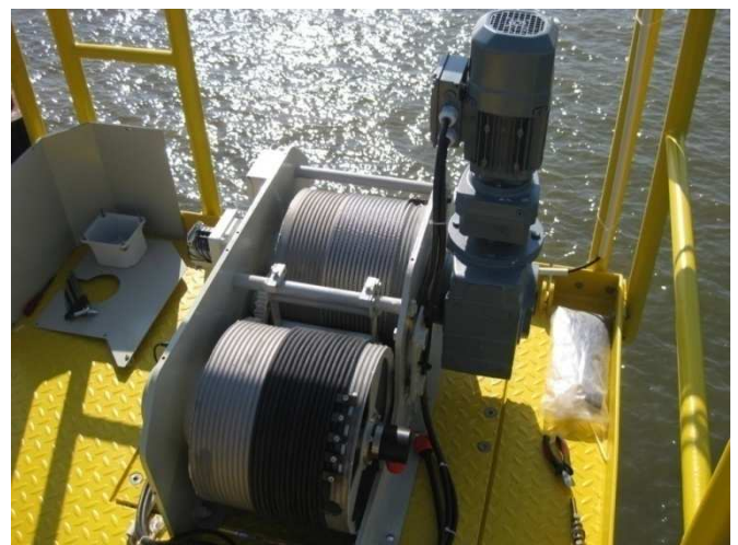
Fig. 3: Treuil pour le déplacement vertical du chariot
