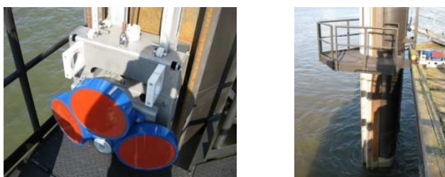
Fig. 2: Chariot (à gauche) et guidage de HADCP (à droite)
