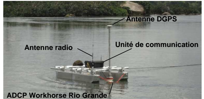
Fig. 3: Ponton comme porte de dispositif avec ADCP
