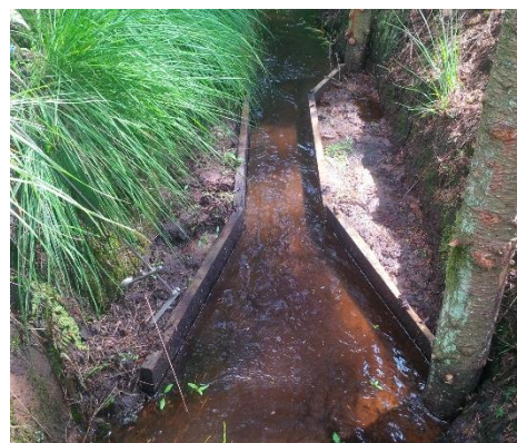
Fig. 3: Chenal de mesure dans les „Krickmeeren“
