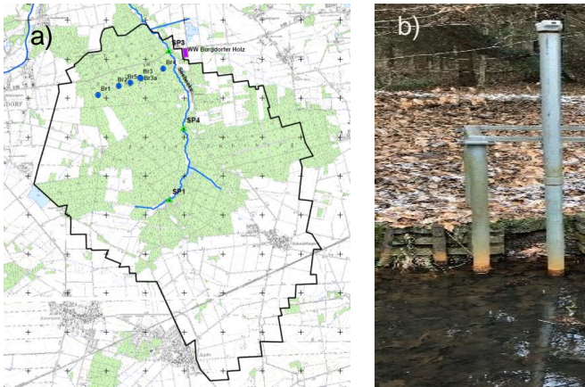
Fig. 1: Bassin versant et puits de l'association pour l'aménagement des eaux de Burgdorfer Holz (a) et limnimètre SP1 sur la partie supérieure de la Seebeeke (b)
