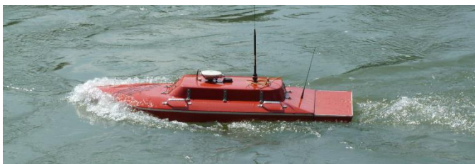
Fig. 2: Bateau de mesure ADCP téléguidé
